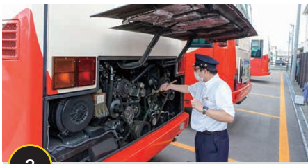
3 日常点検(エンジンルーム)
