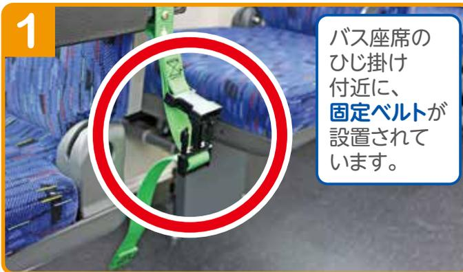
1 バス座席のひじ掛け付近に、固定ベルトが設置されています。
