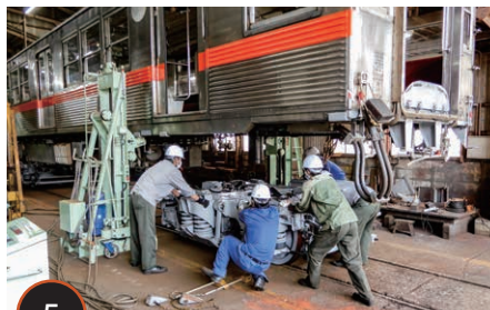
5 台車入れ替え作業
